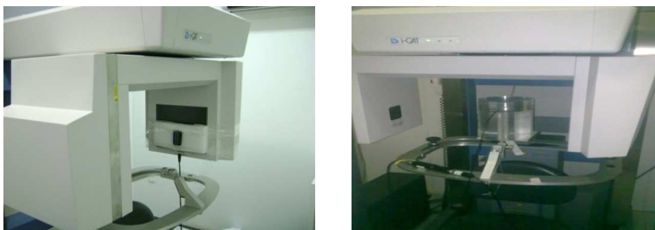
Figura 2: (A) Sensor de kV e tempo posicionado na frente do receptor de imagem. (B) Posicionamento do simulador de PMMA na condição de medida.
