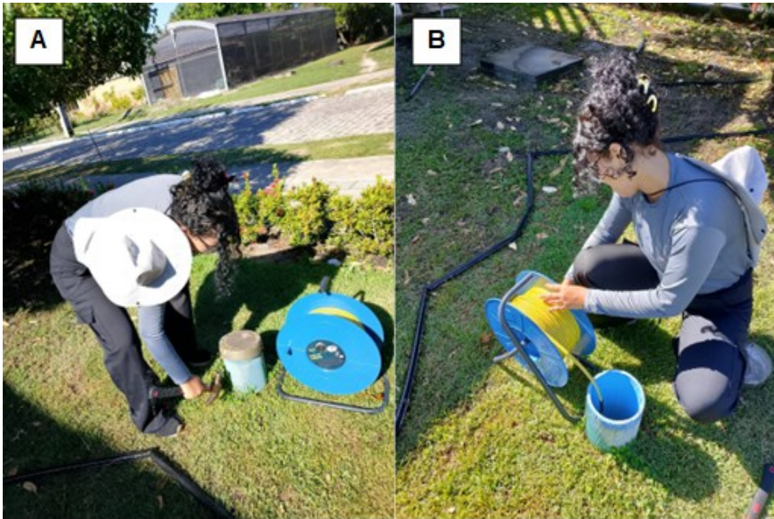
Figura 2: Procedimento de medição semanal do nível d'água subterrâneo, utilizando medidor elétrico com fita milimetrada: (A) poço protegido com tampa; (B) etapa de inserção do equipamento para medição.
