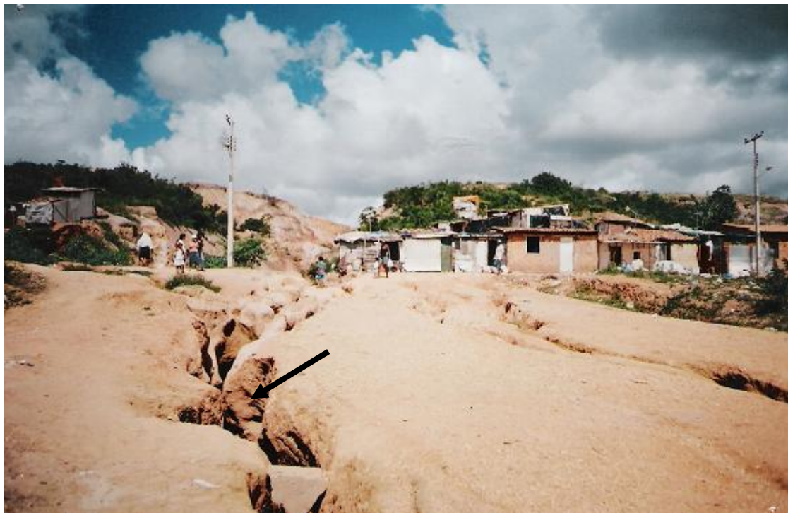
Figura 03 – Ocupação desordenada de casas pela população de baixa renda no morro do avião (bairro Santa Maria - Aracaju), verificando-se abaixo o poder erosivo do escoamento superficial pluvial. Créditos: Eline Almeida, 2003.
