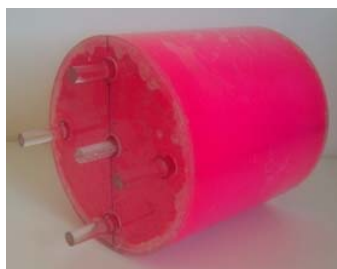
Figura 6. Fotografia dos tarugos nos orifícios não ocupados por detectores.
