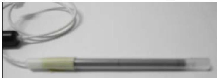
Figura 2: Fotografia de uma câmara de ionização tipo lápis, utilizada na dosimetria de TC
