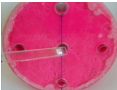
Figura 4. Fotografia do suporte para medida do MSAD com TLDs.
