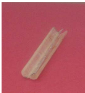
Figura 5. Fotografia do suporte para TLDs no cálculo do CTDI_{100} .
