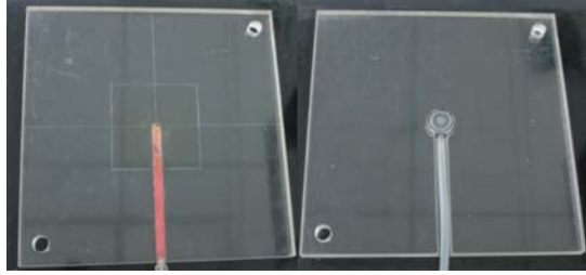
Figura 2: Placas desenvolvidas para acomodar o suporte com o fototransistor (à esquerda) e para acomodar a câmara Markus (à direita), com os respectivos detectores.
