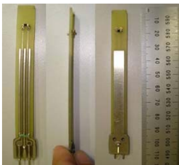
Figura 1: Vista posterior, lateral e frontal da placa de circuito impresso com dois fototransistores OP520, funcionando como um detector.
