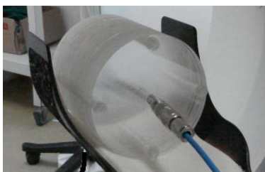
Figura 3: Arranjo experimental para avaliação da dose no simulador de cabeça.
