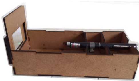
Figura 1 - Aparato experimental contendo suporte para caneta laser e suporte para posicionamento do fio.
