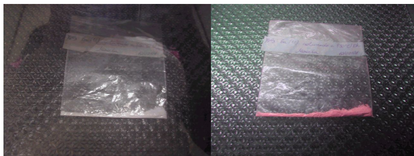
Figura 7. Y_2O_3:Eu^{3+} sem a incidência da luz ultravioleta (lado direito) e com a incidência da luz (lado esquerdo).
