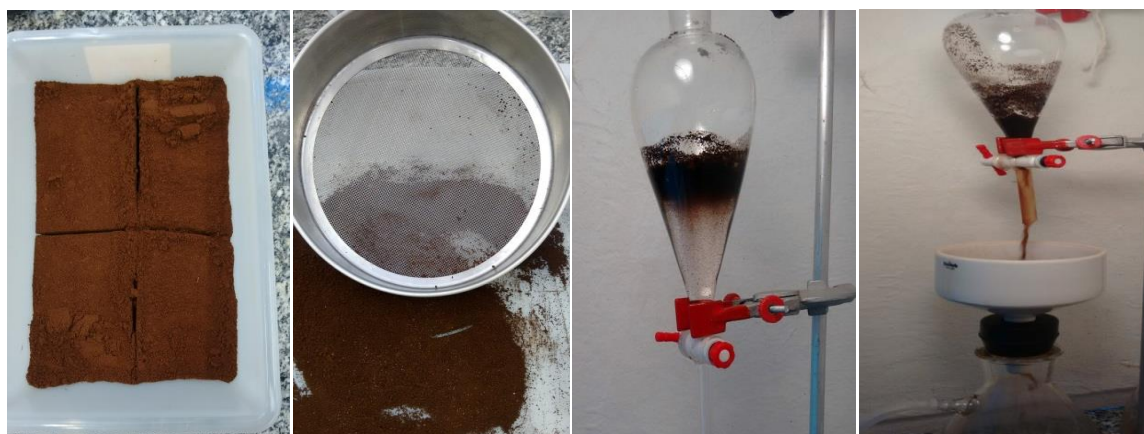
Figura 1- Procedimento realizado para isolamento de sujidades pesadas. Da esquerda para direita: quarteamento, tamisação, decantação das sujidades em clorofórmio, coleta do material decantado para filtração.
