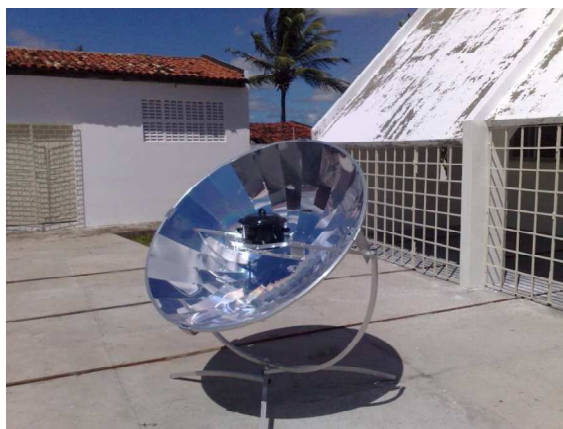
Figura 2 – Fogão solar tipo parabólico (fogão solar da cozinha escola experimental solar –CEES, Aracaju-SE).
