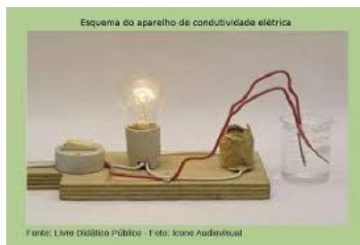
Figura 03: Instrumento utilizado para medir a condutividade elétrica
