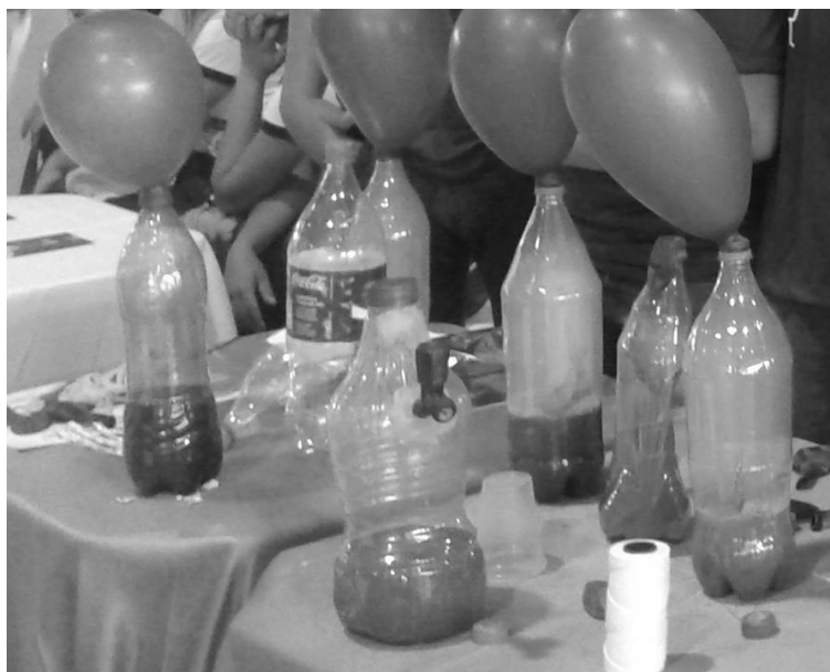
Figura 2: Experimento para a produção de H_2 .
