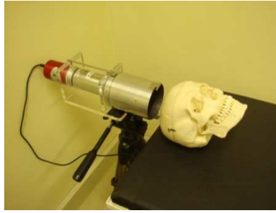
Figura 1: Setup de calibração do detector NaI(Tl) 3"x3" com simulador de crânio no Laboratório de Dosimetria Interna In vivo do CRCN/NE.
